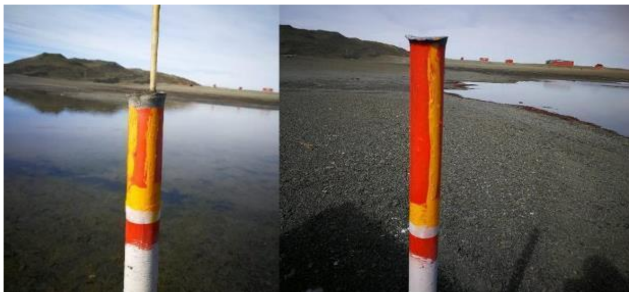
Figura 70: Marcación con anillo amarillo para mediar hacia arriba la altura de relleno necesario para el proyecto.
